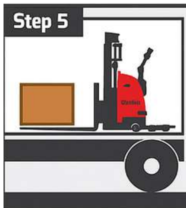
Las patas del apilador se deslizan hacia el frente
